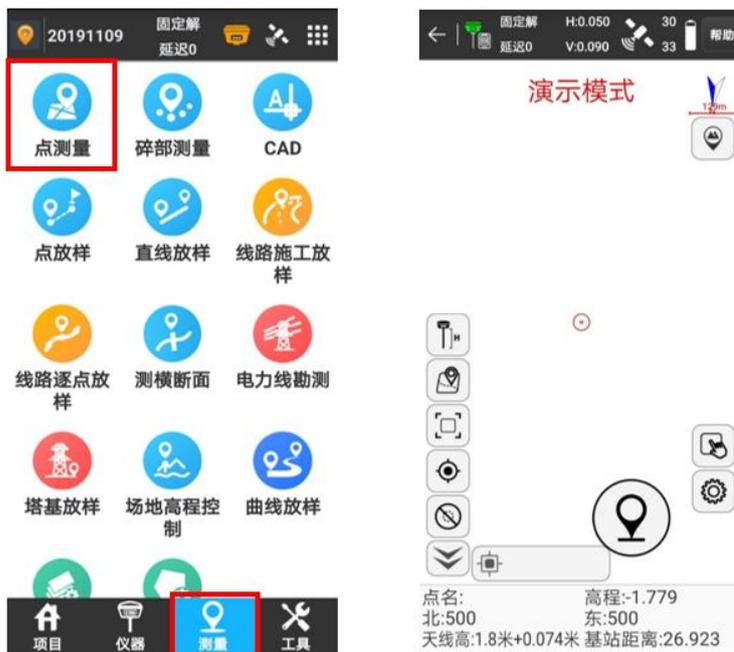
2. 点击【天线图标
