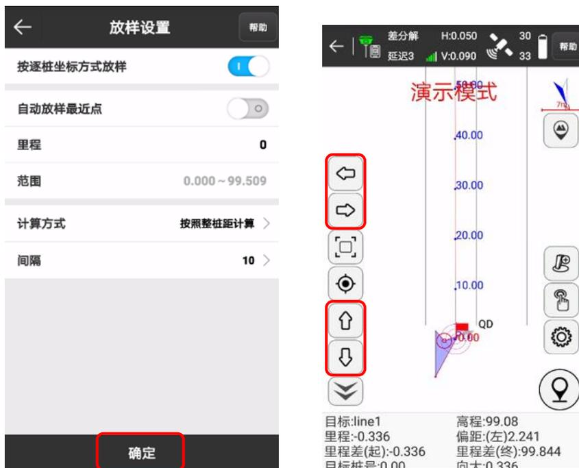
默认线放样模式，界面如图，下面状态栏提示左右偏距和里程偏距，通过偏距可确定放样点与
