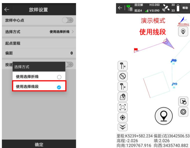
7. 根据实际需要，可以在图形放样设置中开启**按逐桩坐标方式放样**，将图形按照**指定距离**，**线段等分**和**关键节点**三种方式进行逐点放样
