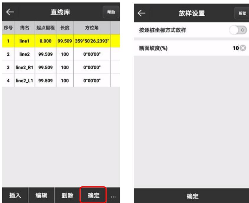
可以选择逐桩放样，并可以设置放样的起始点里程、放样的里程范围及逐桩的计算方式和间隔距离（单位：米），设置好放样方式后，点击【确定】
