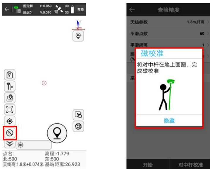
3. 完成磁校准后，引导动画会自动跳转到惯导初始化操作，根据动画和文字提示进行初始化
