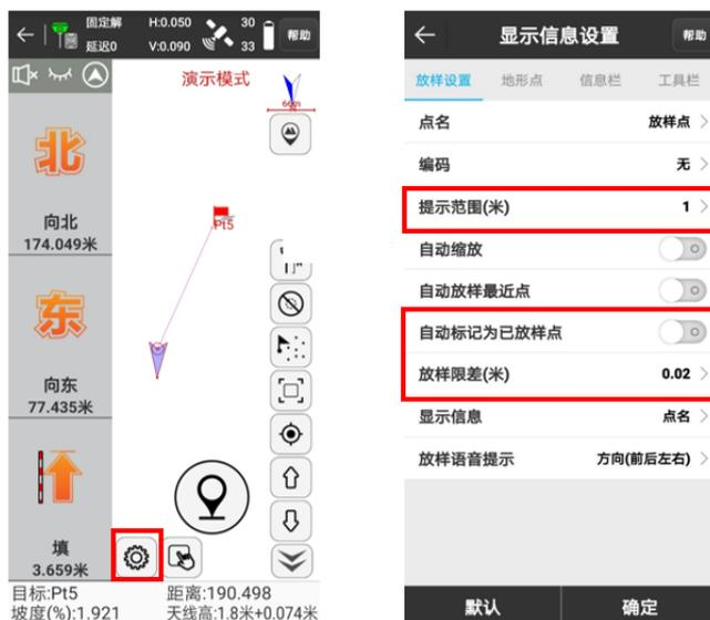
3. 按照信息栏提示找到放样点，气泡保持居中，点击图标
