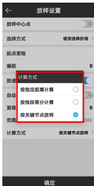
a) **指定距离**: 输入指定的距离间隔，将图形要素按指定的距离分段，进行各节点放样
