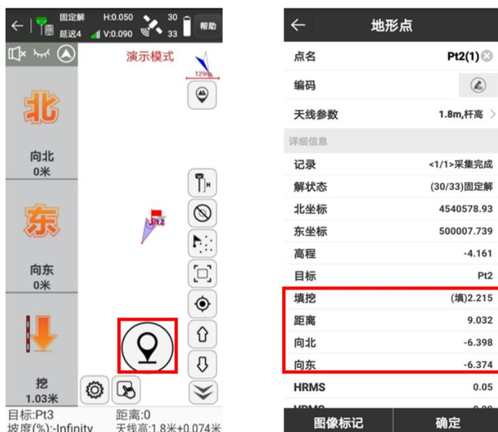
4. 在距离式放样界面点击左上图标可以切换为罗盘式放样界面，罗盘式放样分为两个阶段，放样距离是设置的提示范围两倍时，阶段一（左图）变为阶段二（右图）
