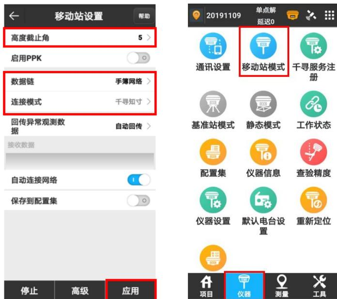
移动站设置成功后自动返回主界面，再次点击【移动站模式】，查看接收数据进度条是否循环读取，循环读取则设置成功，返回即可
