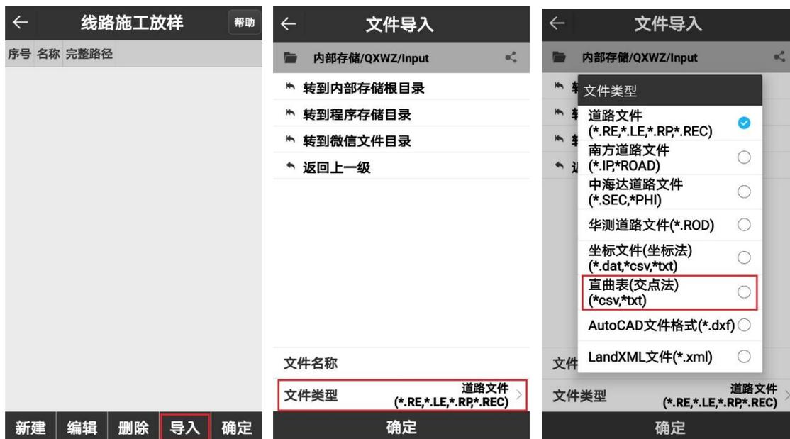
选中文件“平曲线-直曲表导入演示数据.csv”，点击确定，进入配置参数界面，依次选择，点名列表数、北坐标列表数、东坐标列表数、交点桩号列表数、半径列表数、第一缓曲长度列表数、第二换曲长度列表数，对于标准交点(不是非对称、虚交)，可以不导入缓和曲线参数、以及直线长度。
