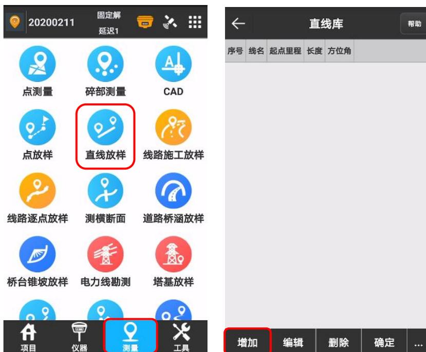
输入直线名称，输入起点里程，线段的输入方式有两种：起点+起点、起点+角度+长度，下面以起点+起点输入方式为例，分别输入起点坐标和终点坐标，也可以通过按钮📍现场采集，或
