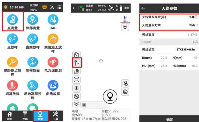
2. 杆高正确输入后，点击惯导开启按钮，开启惯导测量模式，会自动弹出惯导初始化操作引导动画和文字说明，首先进行磁校准，根据文字提示及动画完成操作
