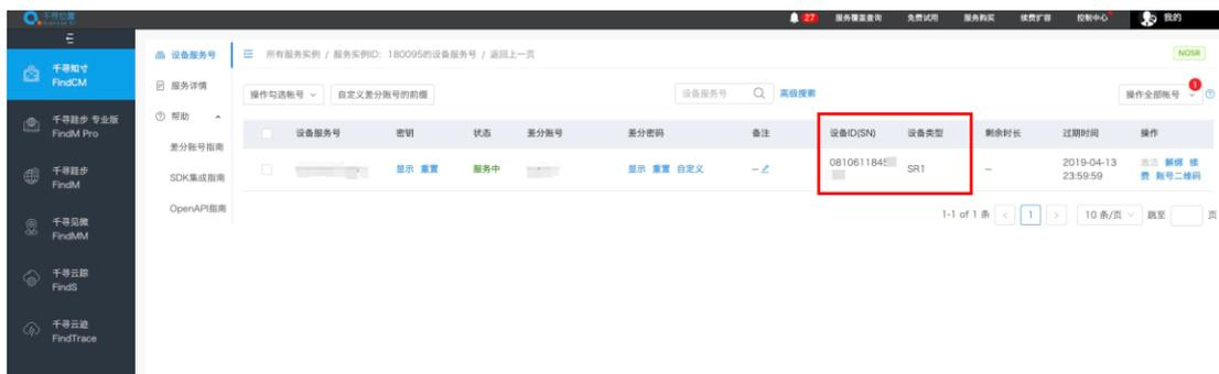
3. 完成服务注册后，终端第一次连接时会自动完成绑定，在上述页面，SN 号及设备类型会自动完成写入。用户可与千寻星矩 SR1&3 接收机外壳底部标签上的 SN 号（14 位）进行核查确认。
