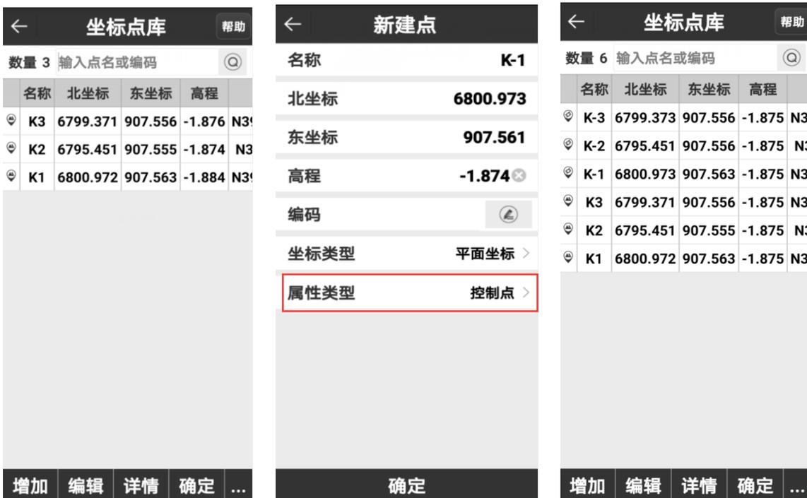
参数计算，点击【工具】→【计算转换参数】→【...】→【选项】选择坐标转换方法“平面平差+垂直平差”，点击【确定】；【增加】进入坐标选择界面，分别点击红框位置选择【当前坐标系已知点】坐标及对应的【椭球原始坐标】（测量点坐标），重复操作，将所有已知点添加进去，点计算。
