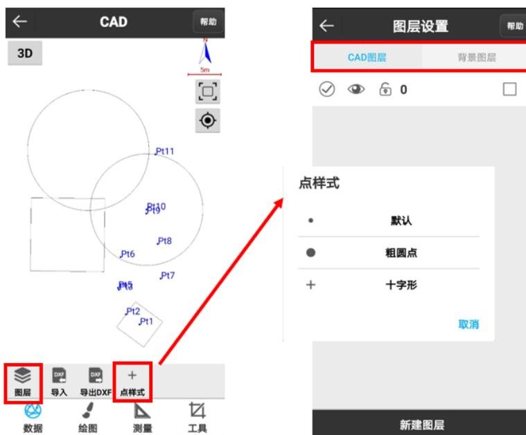
3. 打开手簿文件管理，将要导入的底图存放在路径 QXWZ-Input 下，点击【导入】，在存储目录下找到目标文件，点击【确定】即可导入\*dxf 格式图形数据，点击全屏按钮可进行导入图形的全屏显示
